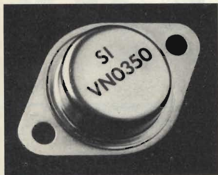
Transistore ad alta corrente e alta tensione realizzato con il processo silicon gate.
