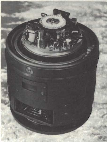
Fig. 6 - Girobussola nella quale è stato sfruttato ampiamente il principio della modularità. Si tratta del modello SIRIUS MK2, della Microtecnica.
