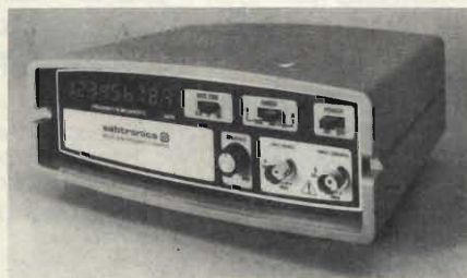
Contatore economico di frequenza, funzionante da 10 Hz a 1 GHz.
